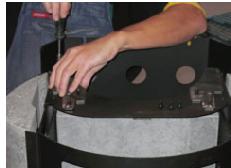
25. Danach die beiden beiliegenden Beschläge in den gleichen Löchern montieren.
