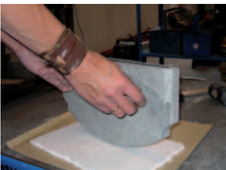
21. Während der Montage den Speckstein gut schützen.
