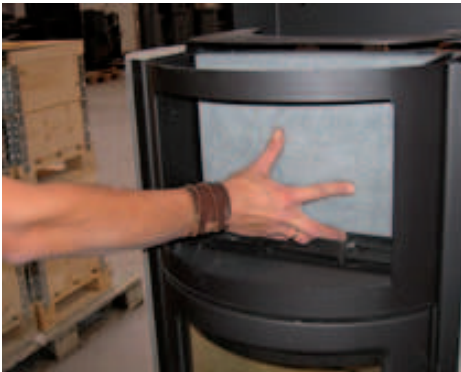
18. Hintere senkrechte Kachel im Warmhaltefach montieren.
