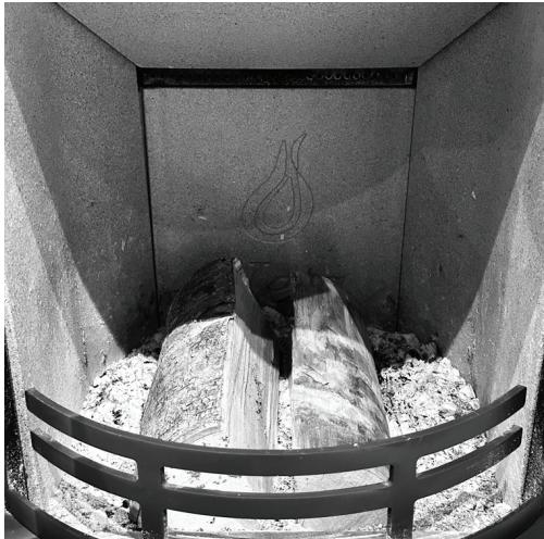
Sorgen Sie beim Anheizen dafür, dass das Brennmaterial nicht zu dicht liegt, da dies zu schlechter Verbrennung und damit zu geringerer Ausnutzung des Brennmaterials führt.
