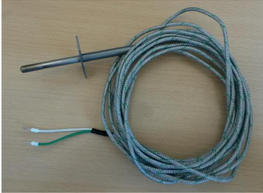
**Das weiße und grüne Kabel durch die Öffnung führen, in der die Schraube saß.**
